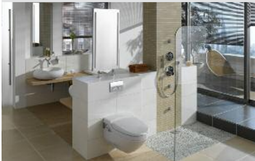
Die Vorwandinstallation gliedert das Bad in verschiedene Nutzungszonen.
